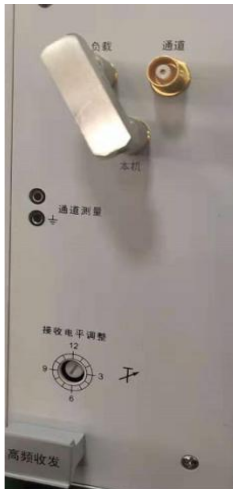
图 2：单机测试工作方式
